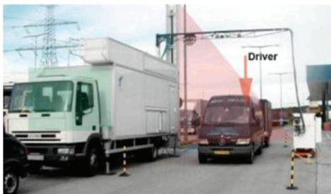
Фото 2 демонстрирует силуэтный метод сканирования - (300 кэВ) двухэнергетический рентгеновский аппарат, непрерывное воздействие. Водитель сидит внутри сканирующегося при движении транспортного средства.
