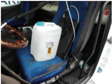
Для того чтобы надлежащим способом откалибровать измерительную аппаратуру радиационного контроля и индивидуальные дозиметры, а также обеспечить надежность измерений, специалистами по радиационной защите были заранее проведены консультации, а также была запрошена документация по сертификации сканера и протоколы по радиационной защите. На фото 1 показана канистра с водой, заменяющая водителя, и дозиметр на водительском сиденье в кабине сканируемого грузовика.
