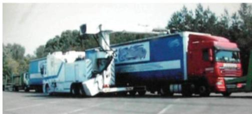
Чтобы ускорить процесс сканирования (процесс проверки), мобильные технологии LINAC позволяют инспекторам сканировать очередь из выровненных, припаркованных транспортных средств, как показано на фото 5. Водители не находятся внутри кабины. Фото 5 демонстрирует LINAC, устройство рентгеновского сканирования (тип - 4,5 МэВ, импульсное воздействие), которое сканирует очередь, выстроенную из грузовиков.
