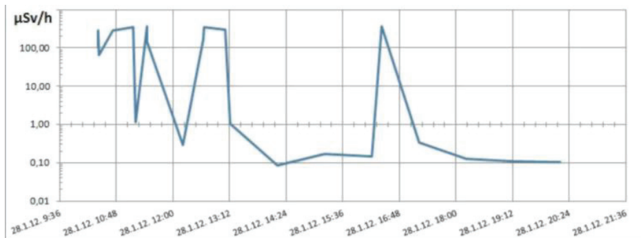
График 1 - мощность дозы по времени; частота и точное время повторного сканирования одним и тем же дозиметром
