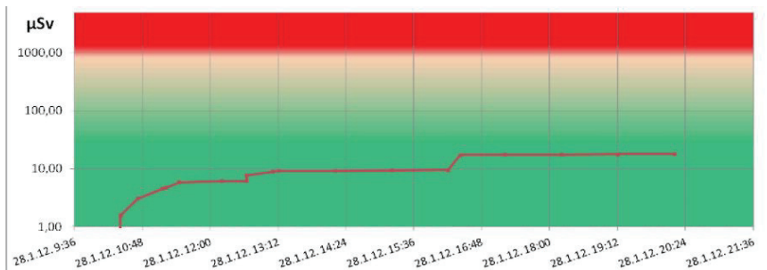
График 2 - ALARA OD накопленная доза, соответствующая частоте сканирования и времени сканирования, показанная на графике 1. Измерительный прибор был помещен в кабину грузовика и / или на сиденье водителя во время нескольких процессов сканирования LINAC в течение одного дня.
